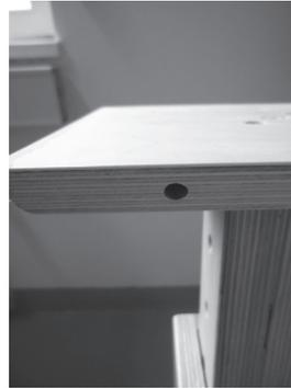
Der Dübel zur Fixierung des Oberteils muss in dieses Loch geschoben werden. Schieben Sie das Oberteil so auf die Platte, dass das Oberteil mit dem Dübel fixiert werden kann.
