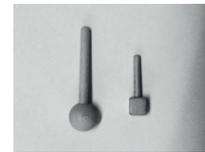
Fixierungsdübel für den Sockel und Fixierungsdübel zur Justierung des Oberteils
