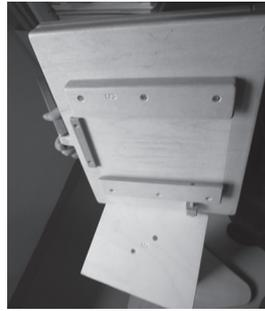
Die Schienen auf der Unterseite des Oberteils werden auf die Platte geschoben.
